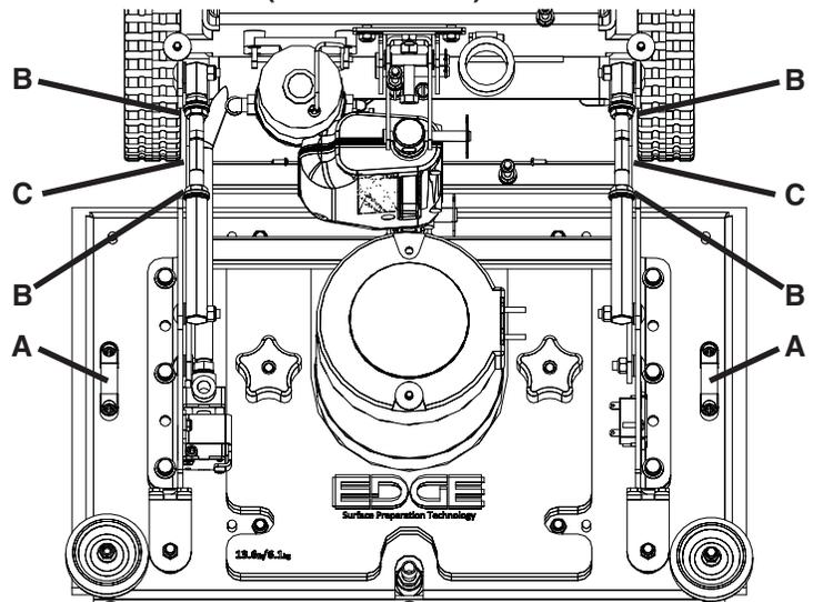
6. Ausfahren der einstellbaren Arme heben und senken Sie die vordere den hinteren Teil des Scrubdeck.
