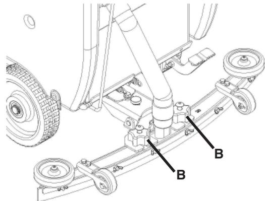
2. Lösen Sie die beiden Schrauben (B) auf dem Raket und schieben Sie sie in die Schlitz in der Raket Montageplatte **(SIEHE UNTEN)**.
