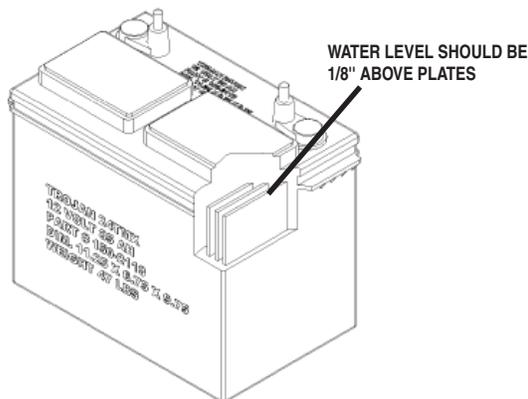
2. Batterie reinigen tops um Korrosion zu verhindern.
