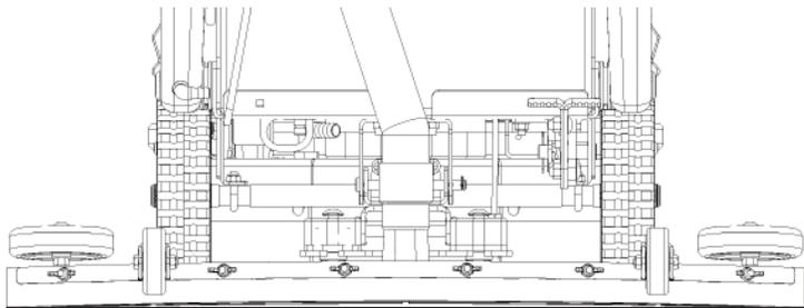
5. Diese Rakel genau richtig mit guten Auslenkung über die gesamte hintere Klinge **(SIEHE UNTEN)** eingestellt.
