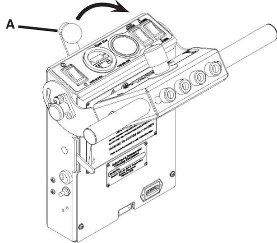
1. Senken Sie den Raket Montageplatte durch Drehen der Raket Fahrstuhl Lever (A) im Uhrzeigersinn **(SIEHE UNTEN)**.
