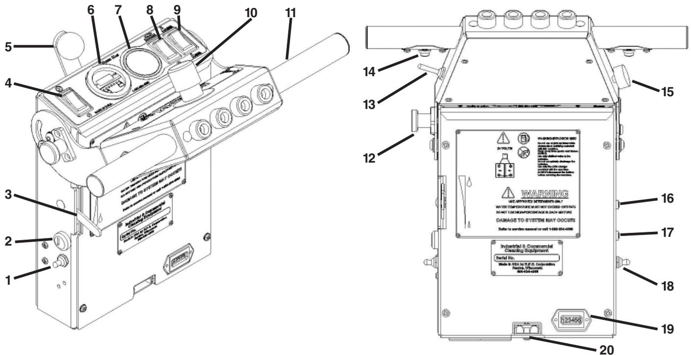
1. **NETZSCHALTER (OPTIONAL):** Schaltet das Gerät EIN und AUS
