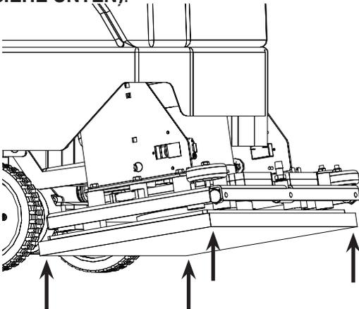
7. Mit Pad sicher an Grip Face of EDGE/ORBITZ Deck befestigt, ist die Maschine betriebsbereit.
