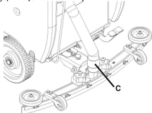
3. Ziehen Sie die beiden Knöpfe und verbinden Sie den Saugschlauch (C) von der Maschine auf die Raket **(SIEHE UNTEN)**.
