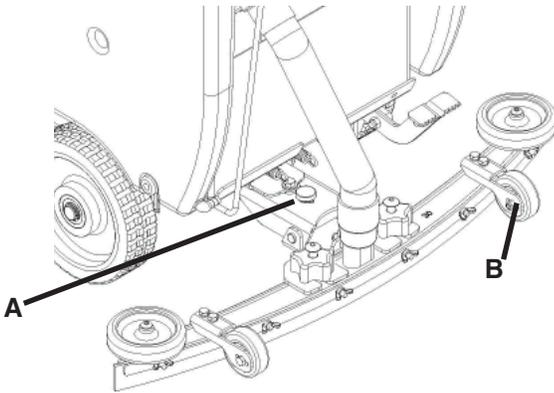
2. Einstellbare Wheel **(B)** **(SIEHE OBEN)** hat 3 Löcher. Je näher an der Maschine das Rad ist, desto weiter vom Boden das Rad wird. Je weiter von der Maschine das Rad ist, desto näher an den Boden des Rades wird.
