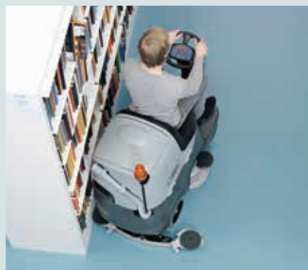
Durch das Entfallen der seitlichen Saugleisten ist randnahes Reinigen möglich – für perfekte Sauberkeit bis an den Rand.
