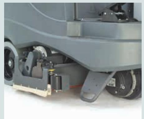
Große Stoßfänger mit Rollen schützen die Seiten des Bürstendecks und die Absaugleiste.
