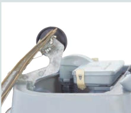
Das eingebaute Absaugleisten-Aufhängungssystem am Schmutzwassertank vereinfacht das Überführen der Maschine in enge Bereiche.
